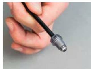
DIN flaring process
