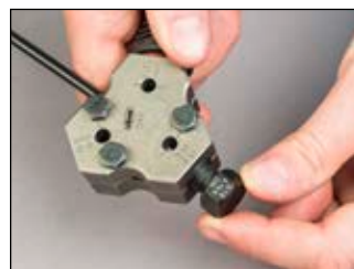
DIN flaring process
